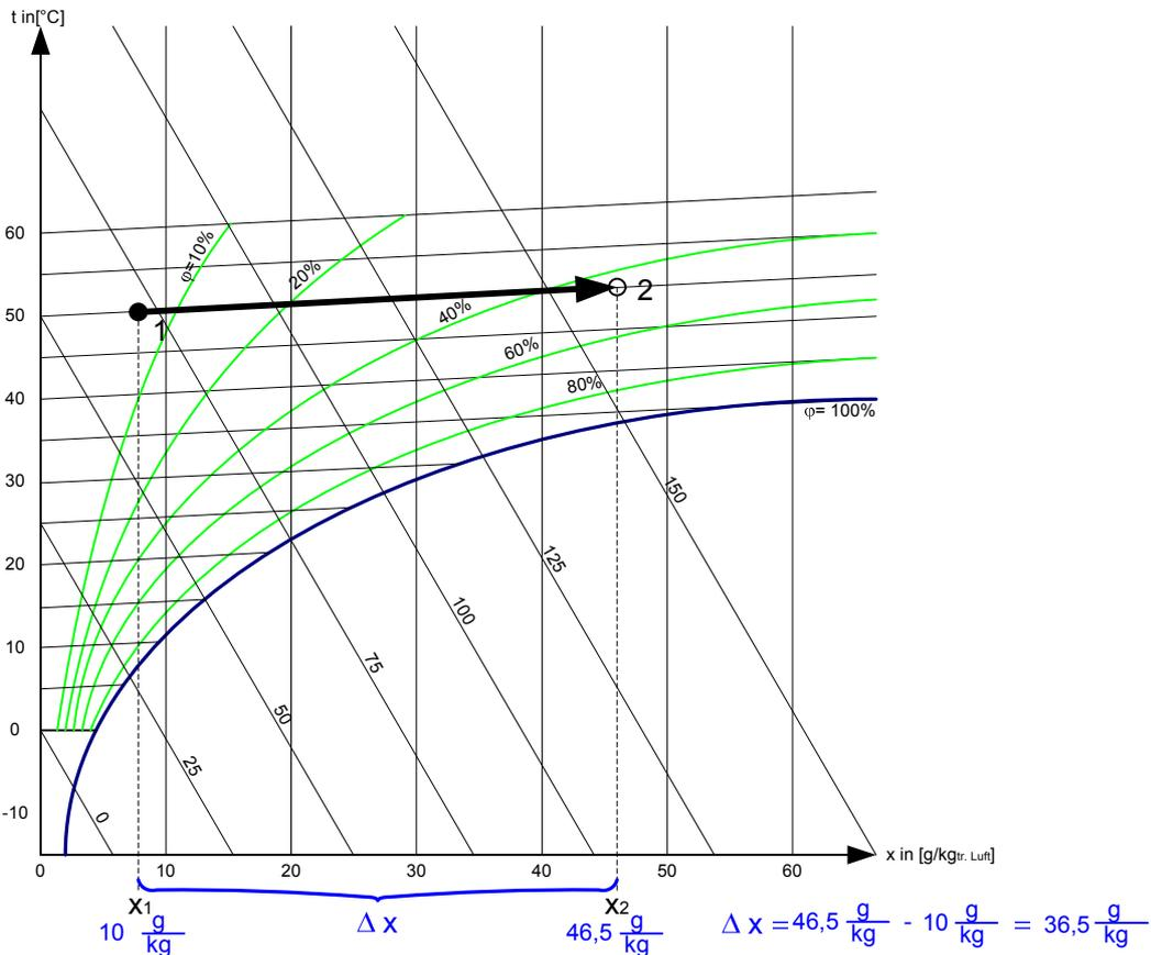
Bei der Befeuchtung von Luft mit Sattdampf **befeuchten** wir diese bis auf einen bestimmten, neuen Luftzustand. Es ändern sich auch die Dichte (geringe Zunahme), die relative Feuchte (nimmt zu), die Enthalpie und der absolute Wassergehalt der Luft (nimmt zu).
