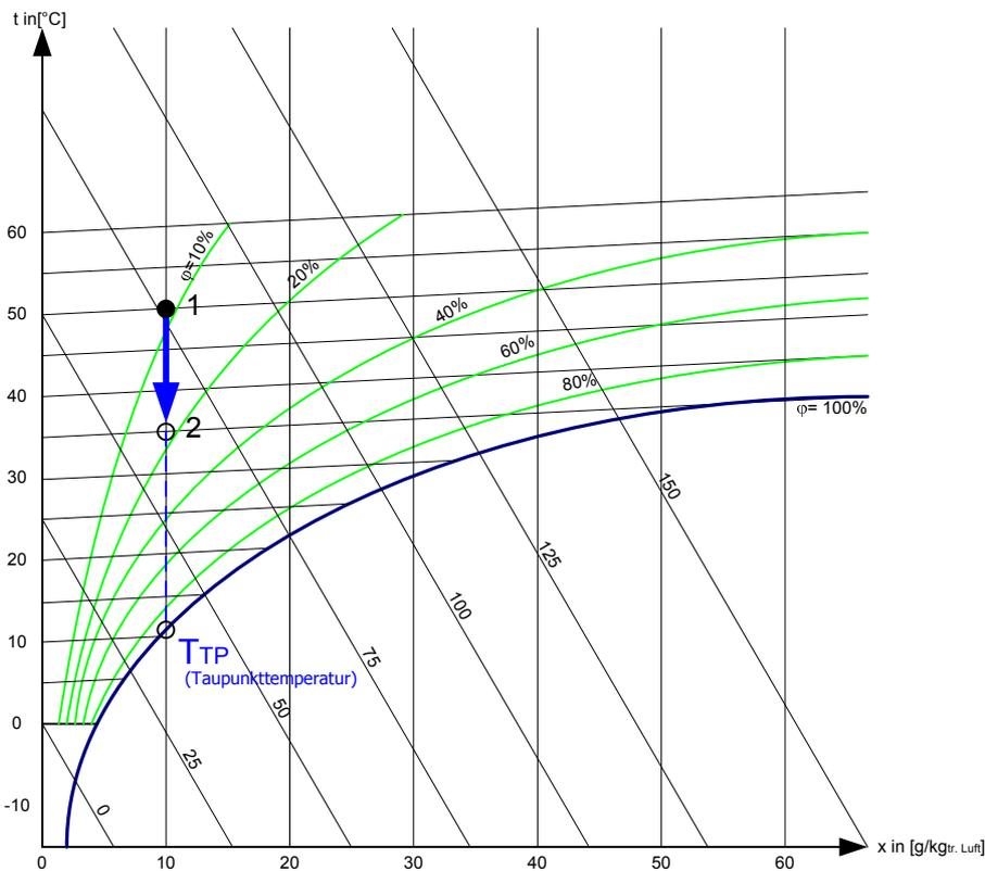
Bei Wärmeentzug aus der Luft **kühlt** sich diese bei **konstanter Feuchte** (absolute Luftfeuchte  $x$  in [g/kg]) ab. Die trockene Kühlung verläuft wie oben dargestellt senkrecht von oben (Zustandspunkt **1**) nach unten (Zustandspunkt **2**).
