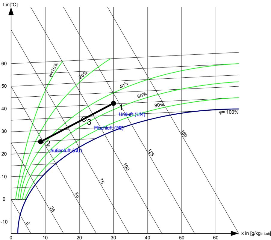
Bei Mischung von zwei Luftständen **kühlen bzw. erwärmen** sich diese bis auf einen bestimmten, neuen Misch-Luftzustand ab bzw. auf. Es ändern sich auch alle anderen physikalischen Größen.
