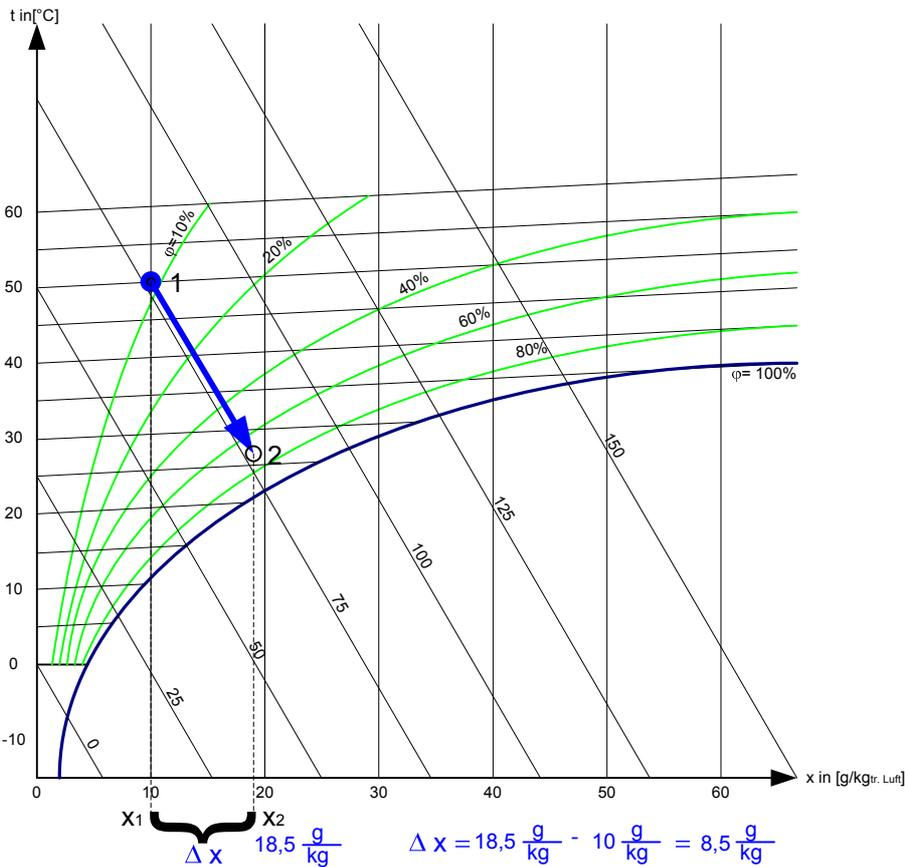
Bei der Befeuchtung von Luft mit Wasser **befeuchten und kühlen** wir diese bis auf einen bestimmten, neuen Luftzustand. Es ändern sich auch die Dichte (nimmt zu), die relative Feuchte (nimmt zu) und der absolute Wassergehalt (nimmt zu) der Luft.
