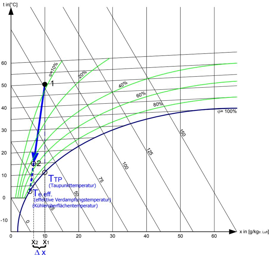
Bei Wärmeentzug aus der Luft **kühlt** sich diese bis auf eine bestimmte, neue Temperatur ab.
